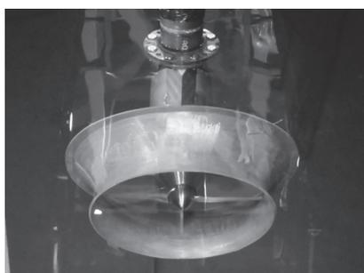
図2.  $\Sigma Flow_{TM}$  — 羽根車、羽根車周囲のフローガイド、及び発電機を一体構造とし、支柱で上方から支持する構造である。
