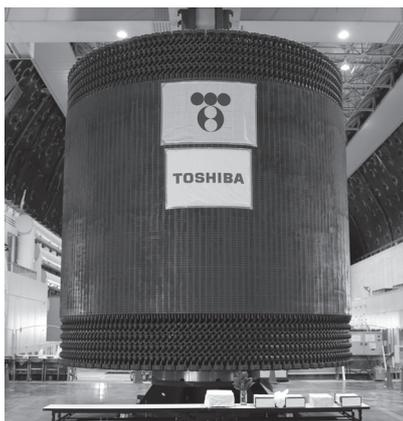
図6. 475 MVA-500 min<sup>-1</sup> 発電電動機の回転子 — 円筒構造を持ち、上下コイルエンド部は東芝独自のUボルト方式で支持し、冷却性能と保守性に優れている。
