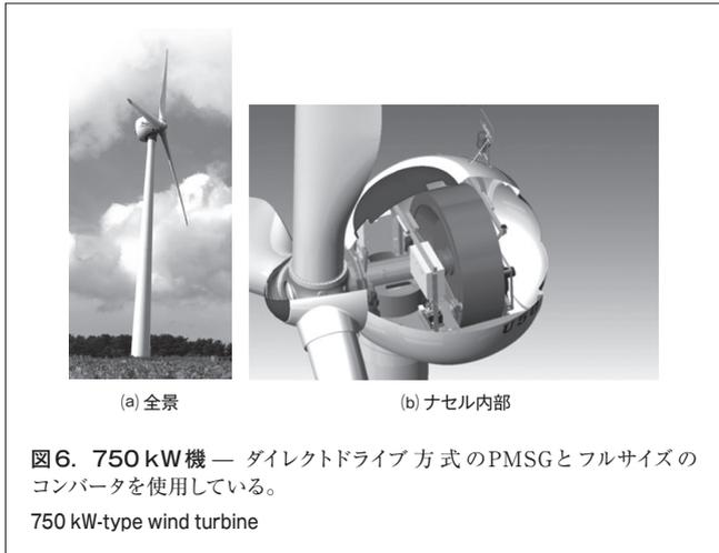
コンバータを介して系統に接続する構成である。長期信頼性と耐久性を確保した先進のドライブトレイン、高効率で保守が容易な発電機、及びフルサイズのAC/DC/ACコンバータによる高効率運転と高い系統親和性、などの特長がある。
