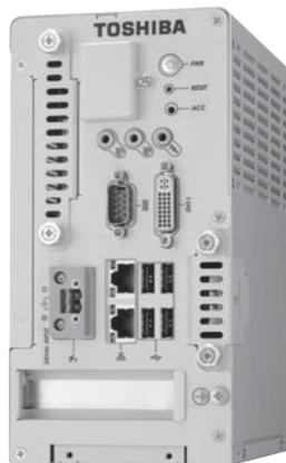
図1. EC20 model 100 — 小型ボックス型の筐体を持ち、インタフェース類はフロントに集約している。
