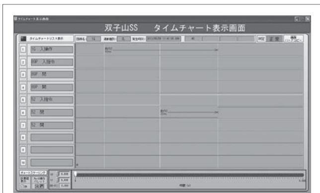
図6. タイムチャートの表示画面例 — 各機器の制御ごとにタイムチャートを1msサンプリングの高精度で記録し, タイムチャート画面で確認することができる。
