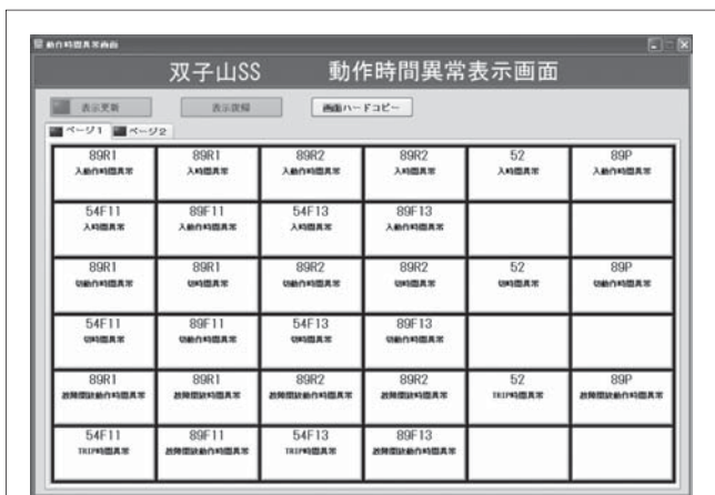
図7. 動作時間の異常表示画面例 — 各機器が一定時間内に動作しない場合は異常として検出し, その内容を動作時間の異常表示画面に表示する。
