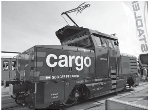
図9. パンタグラフを持つハイブリッド車両の展示 — Stadler社から出展された。蓄電池は搭載せず、電化/非電化区間の走行に対応している。
