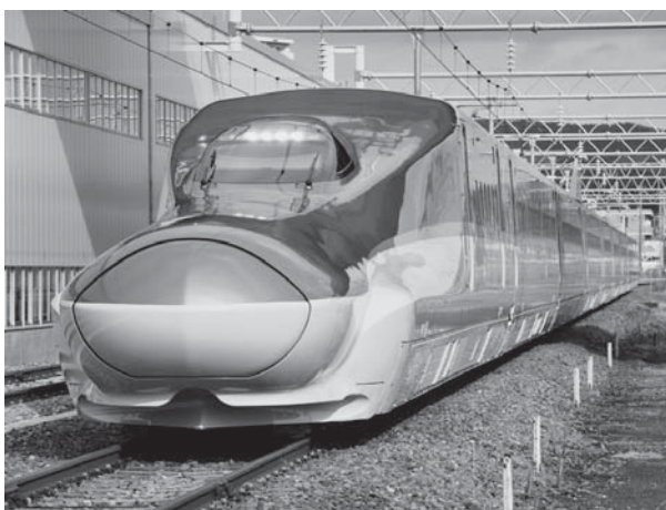
図1. E5系新幹線 — 320 km/hの営業運転を開始したE5系の主変換装置は、E2系のそれと比べて約18%の軽量化が図られた。 E5 series Shinkansen
