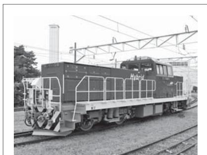
図3. 日本貨物鉄道（株）HD300形式ハイブリッド機関車 — 蓄電池を搭載したハイブリッド方式のディーゼル電気機関車であり、燃料消費量、NO<sub>x</sub>排出量、及び騒音レベルを大幅に低減した。
