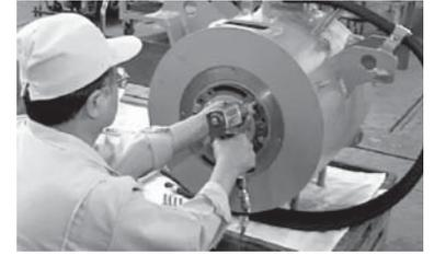
図9. 全閉電動機の非分解軸受部交換 — 電動機を分解せずに軸受部をメンテナンスできる。
