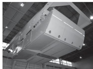
図5. 東海旅客鉄道（株）N700A用小型プロワレス主変換装置 — 走行風による冷却を用いた主変換装置を元に、更なる小型化を実現した。
