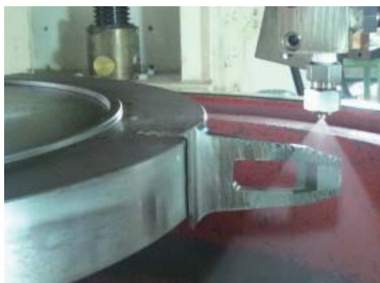
回転試験片へのミスト噴霧状況 (丸和電機(株)において) Mist spray for testing of materials (tested at Maruwa Electronic Inc.)
