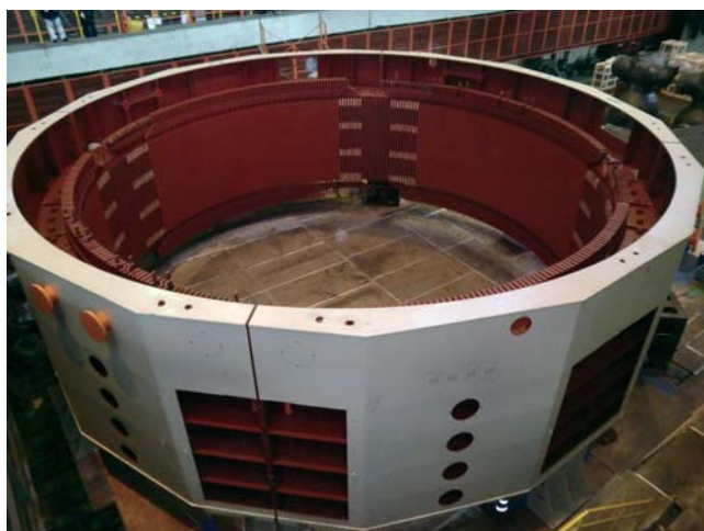
発電機 固定子の工場仮組立
