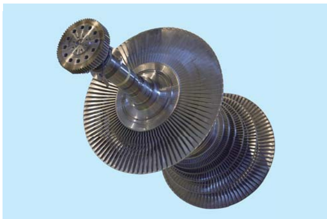
テミヒ地熱発電所のタービン
