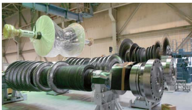
碧南火力発電所1号機の高圧・中圧(低压)タービンロータ
