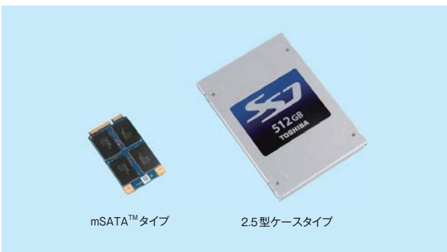
19 nmプロセスのNAND型フラッシュメモリを用いたクライアントSSD SSD using 19 nm-process NAND flash memory
