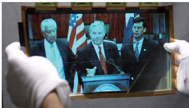
酸化物半導体 (In-Ga-Zn-O) TFT で駆動した 11.7 型有機 EL シートディスプレイ
