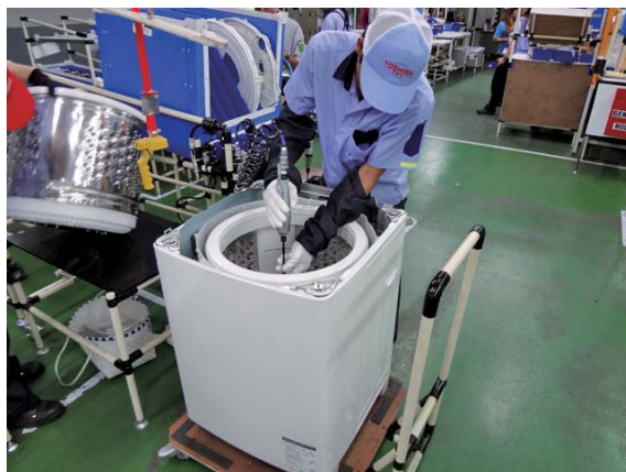
洗濯機組立ての合理化セル
