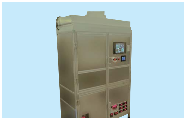
材料の使用効率を最大化する省材料塗布装置
