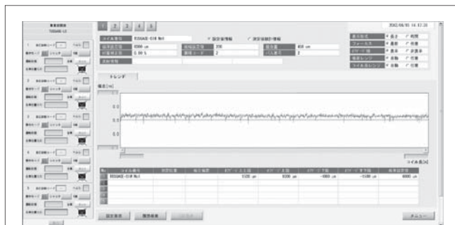
図6. 操作PCのHMI画面 — 測定データのリアルタイム表示や過去の測定データの表示、及び各種設定機能がある。また、ユーザー側で画面を使いやすいようにカスタマイズできる。
