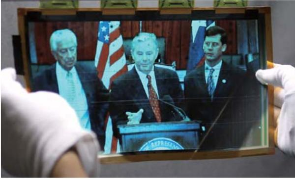
図8. 試作した11.7型シート有機ELディスプレイ—プラスチック基板上に作製したInGaZnO TFTアレイにより、世界最大クラスの有機ELシートディスプレイの駆動を行った。
