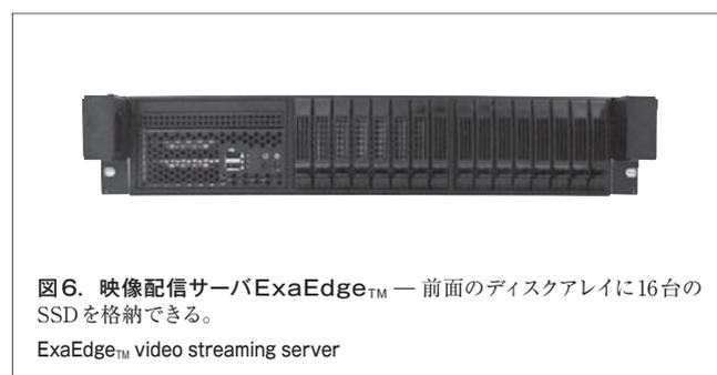
フェースとして、SFP+ (Small Form-Factor Pluggable Plus) を4ポート備えており、それぞれ10 Gigabit Ethernetでネットワークに映像コンテンツを送信できる。40 Gビット/sという配信能力は大手の配信業者にとっても十分な性能である。また、インタフェースに40 Gigabit Ethernetを用いず、10 Gigabit Ethernetを四つのインタフェースとしていることで、比較的安価な10 Gigabit Ethernet機器と接続できる。
