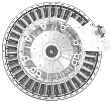
図8. 新モーター — 新モーターでは、コイル数よりもフェライト磁石数が多い構造を採用した。
