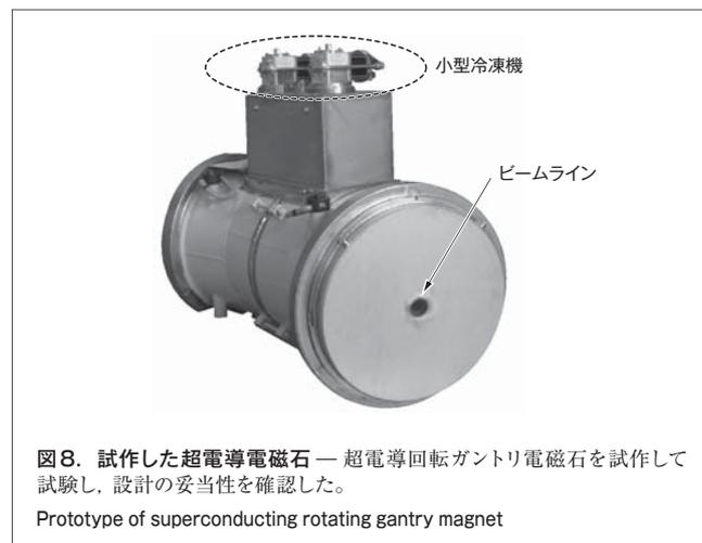
図8. 試作した超電導電磁石 — 超電導回転ガントリ電磁石を試作して試験し、設計の妥当性を確認した。
