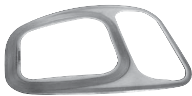
図10. 試作したY系超電導コイル — ひずみを極小にする巻線手法を新たに開発し、FFAG用コイルの一部を模擬して試作した。
