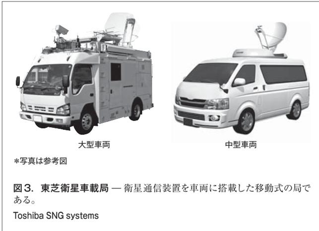
図3. 東芝衛星車載局 — 衛星通信装置を車両に搭載した移動式の局である。
