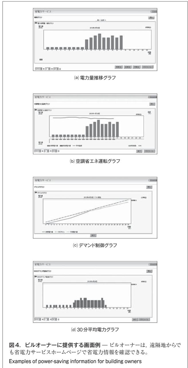
図4(c)はデマンド制御の画面例である。デマンド制御は、30分平均電力が設定最大値以下となるように、1分周期で30分平均電力を予測する。そして最大値を超えると予測された場合にはビルオーナーがあらかじめ定めた停止順に従って、空調や照明などを自動的に停止させる。登録された全ての機器を停止させても最大電力や契約電力を超える場合には、ビルオーナー指定のアドレスに警告メールを送信する。
