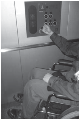
図9. 車椅子利用者による操作例 — 車椅子利用者が実際に車椅子用操作盤を操作して、手すりの形状による操作性の違いを検討した。
