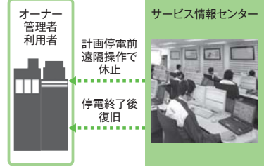
図 10. 計画停電運転休止サービス — 計画停電の際、万一の閉じ込め発生防止のため、東芝エレベータ(株)サービス情報センターから遠隔操作で、エレベーターの休止や平常運転への復帰を行う。
