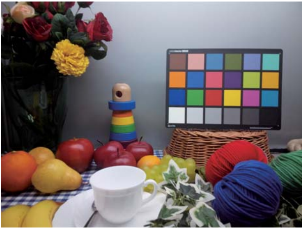
図6. BSI技術を用いたCMOSイメージセンサのカラー再生画像 — BSI技術により、画素サイズ1.12 \mu\text{m} 、800万画素CMOSイメージセンサを実現した。 Color image obtained by 8 Mpixel BSI-type CMOS sensor with individual pixel size of 1.12 \mu\text{m}
