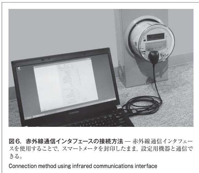
図6. 赤外線通信インタフェースの接続方法 — 赤外線通信インタフェースを使用することで、スマートメータを封印したまま、設定用機器と通信できる。
