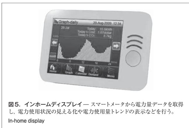
図5. インホームディスプレイ — スマートメータから電力量データを取得し、電力使用状況の見える化や電力使用量トレンドの表示などを行う。
