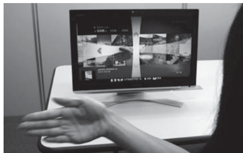
図1. てぶらナビ—自然な手の動きでPCを操作できる。 Tebura-navi voice and gesture integrated user interface
