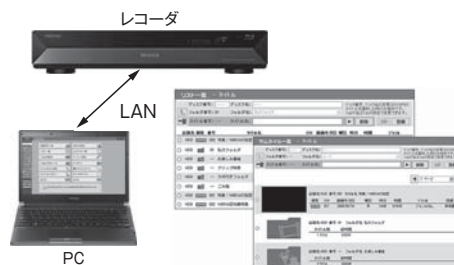
図5. ネットdeナビの概要 — PC上に操作画面を表示してレコーダを遠隔操作する。
