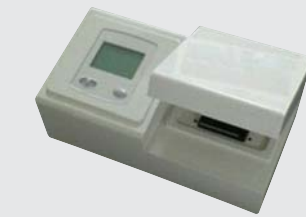
図3. 試作した測定機 — 光源にLED、検出器にフォトダイオードを用いることで、A6サイズレベルのコンパクトな測定器を実現しました。
