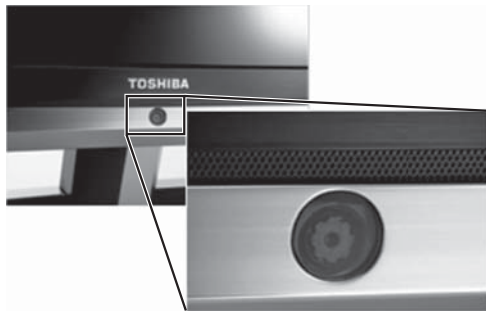
図7. フェイストラッキング用カメラ — フェイストラッキング用カメラを画面中央下に搭載した。
