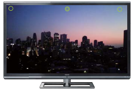
図10. 視聴位置確認マーカ — 3Dで視聴しながら最適位置を確認できるよう、最適位置からだけ見える◎と○印のマーカを表示可能とした。
