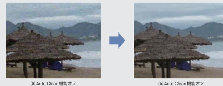
図3. Auto Clean機能の効果 — 再構成型超解像技術を構造適応型ノイズ低減と組み合わせることで、ノイズを低減するとともに、本来の絵柄の鮮鋭度を向上させています。
