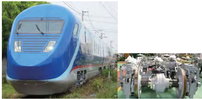
軌間可変電車と改良台車
