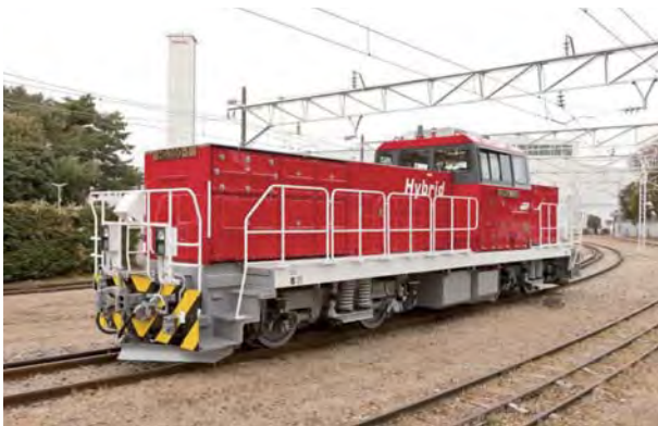
HD300形式ハイブリッド機関車(出場時) Type HD300 diesel hybrid shunting locomotive
