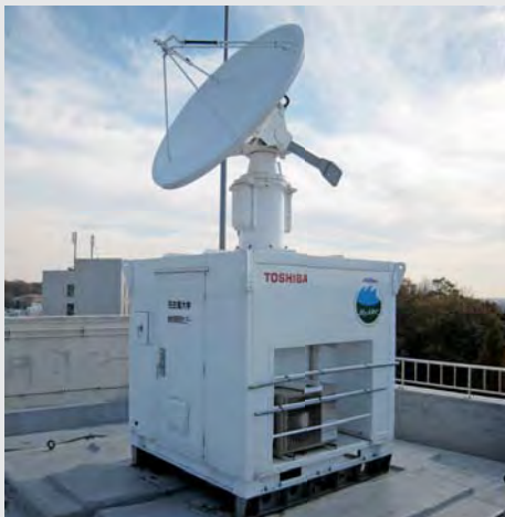
▲ 9 GHz帯固体化マルチパラメータレーダ 9 GHz-band solid-state multiparameter radar
