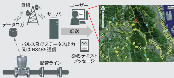
▲ 広域流量監視ネットワーク概念図 Conceptual diagram of network for wide-area flow monitoring
