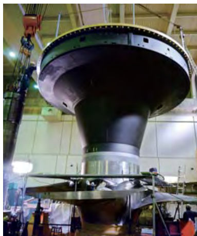
電源開発(株) 船明発電所の水車組立風景
