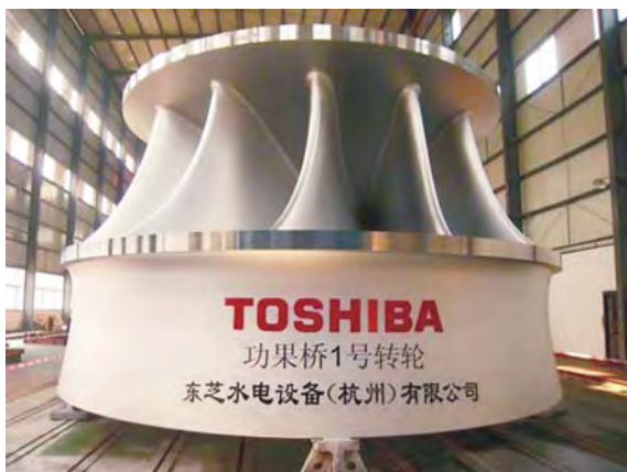
功果橋発電所 現地溶接組立ランナ
