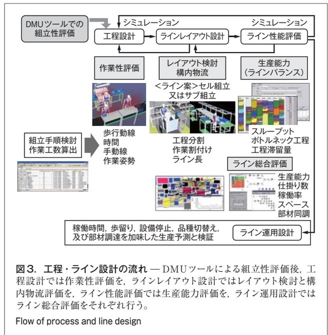
図3. 工程・ライン設計の流れ — DMUツールによる組立性評価後、工程設計では作業性評価を、ラインレイアウト設計ではレイアウト検討と構内物流評価を、ライン性能評価では生産能力評価を、ライン運用設計ではライン総合評価をそれぞれ行う。
