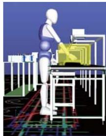
図5. 作業姿勢の評価 — 左側では組付位置が低く作業姿勢が悪いが、コンベアの高さ調整により右側のように作業姿勢が改善された。
