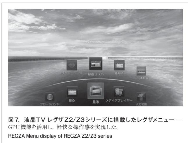
図7. 液晶TV レグザ Z2/Z3シリーズに搭載したレグザメニュー — GPU機能を活用し、軽快な操作感を実現した。
