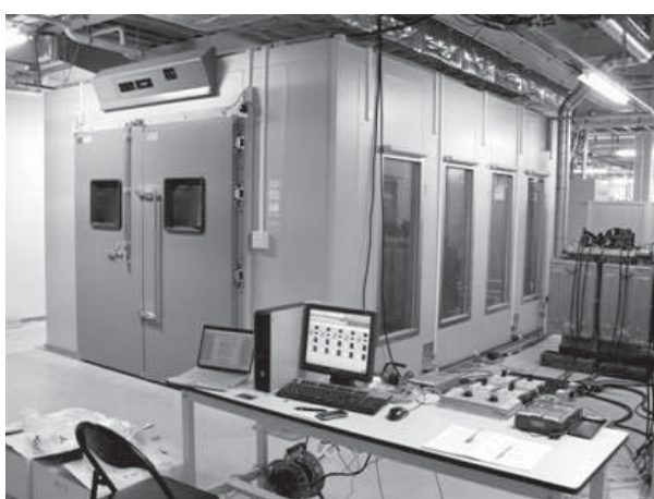
(b) 恒温槽と外部からPCSの動作を監視するパソコン
