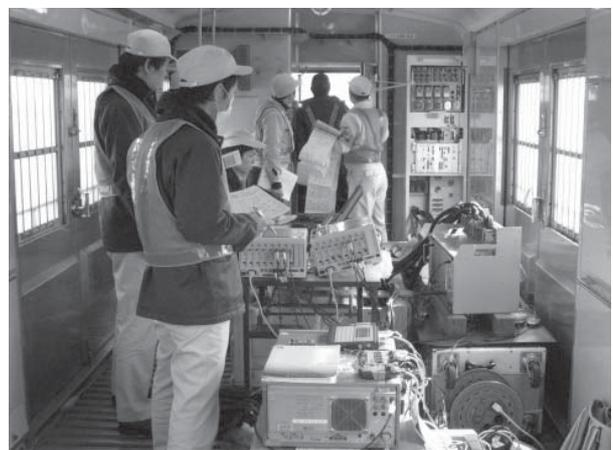
図7. クモヤ143形事業用電車上での試験風景 — ATS-P·Ps統合型車上装置の試験を、クモヤ143形事業用電車で行った。
