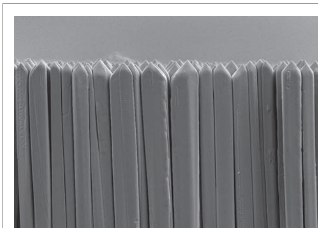
図3. CsIシンチレータ — 細く独立した柱状結晶がライトガイドとなり、光の散乱を抑え高いMTF特性を実現する。 CsI scintillator
