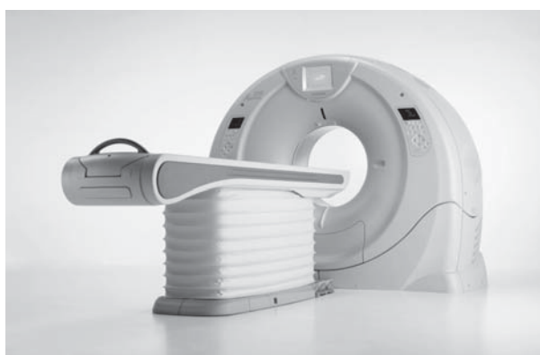
図1. Aquilion ONE™ — 1回転0.35秒で160 mmの範囲を320断面同時に撮影可能なCT装置である。 Aquilion ONE™ CT scanner
