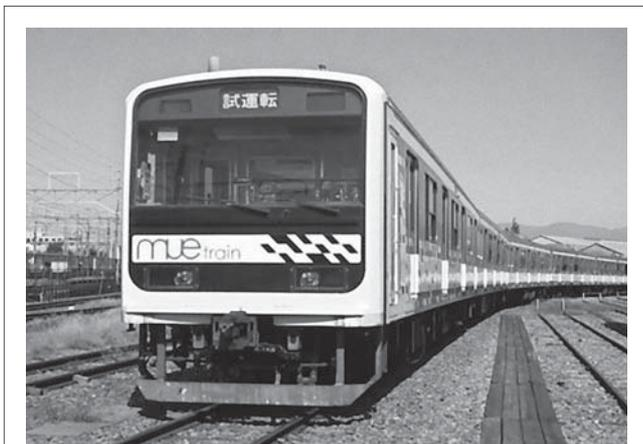
図9. 209系試験電車 — 開発した装置の定格出力容量を260 kVA仕様に変更して搭載した。
