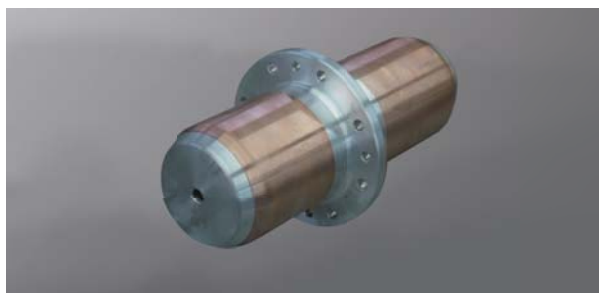
図4. Cu被覆Al導体 — Al導体の外表面をCu材で被覆することで、表皮効果による大容量通電を実現した。
