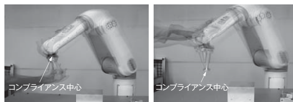
(a) コンプライアンス中心がロボットアーム手先フランジ面にあるとき (b) コンプライアンス中心がツール先端部にあるとき
