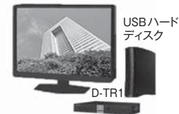
図2. TVとの接続例 — 地上デジタル放送の受信機能のないTVにD-TR1を接続することで, 地上デジタル放送をはじめ, BS・CSデジタル放送を視聴することができる。
