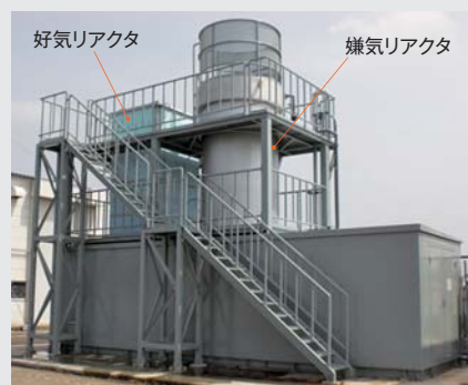
▲ 曝気レス水処理フィールド試験装置 (30 m 3 /日) Non-aeration wastewater treatment system for field tests
