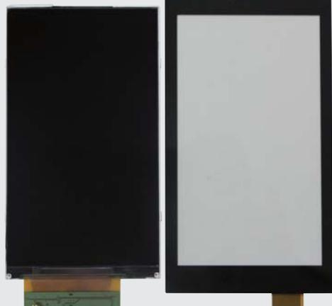
▲ 4型フルWVGA (854×480画素) LCDモジュール (左)、及び静電容量方式タッチパネルモジュール (右)
