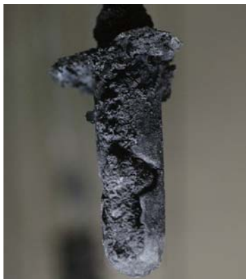
熔融塩電解により電極上に回収した金属 Dy
