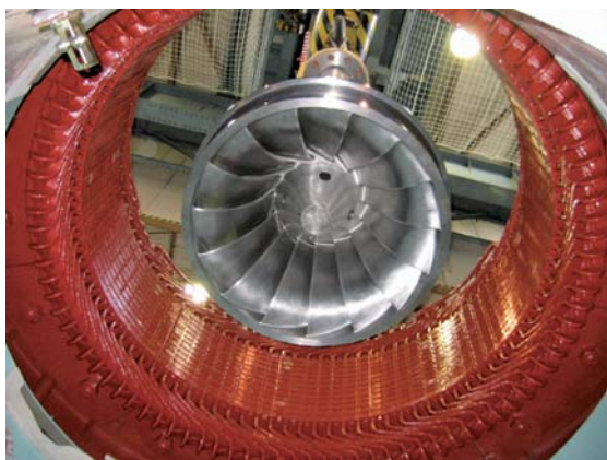
東京電力(株) 駒橋発電所1号機の水車ランナ
