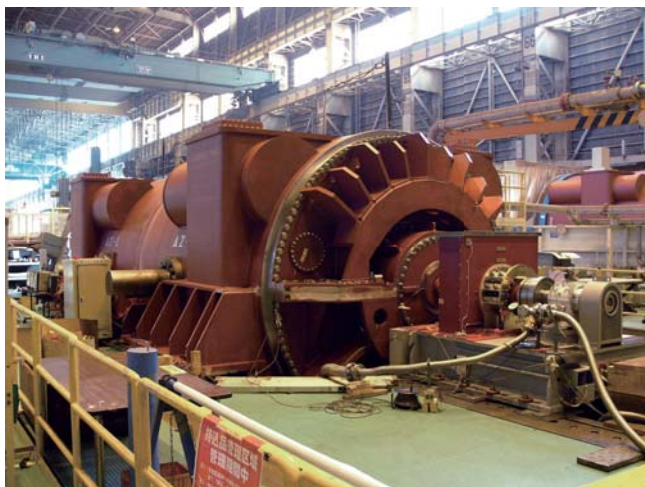
工場における発電機の回転電気試験のようす
