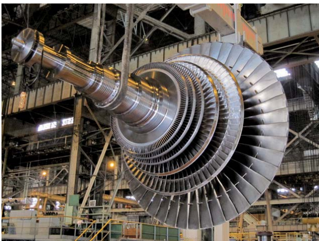
チタン48インチ最終段翼を用いた低圧タービンロータ
