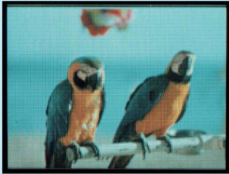
酸化物半導体 TFT で駆動した 3 型有機 EL パネル
