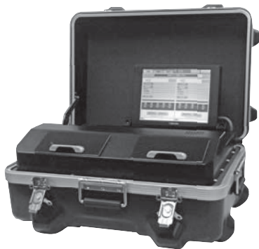
図2. モバイル型全自動DNA検出装置 — 送液と反応温度をコントロールする機構と、電気化学的な検出系を内蔵している。生物剤検知用DNAチップカセットをセットすれば、自動で生物剤の検出を行う。
