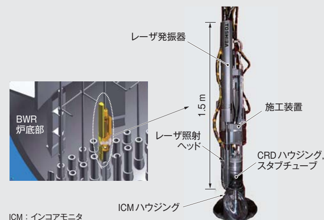
図2. ポータブルレーザービニング装置のBWR炉底部への適用例 — 耐水性のポータブルレーザー発振器を施工装置と一体化してCRDハウジング上部へ設置し、施工部位をビニング施工します。
