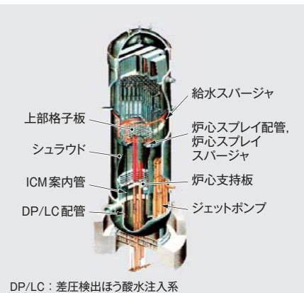
図5. BWRシュラウド取替工法での取替範囲 — シュラウド取替工法における主な取替炉内構造物を示します。通常定期検査時に取外できない機器が更新されます。
