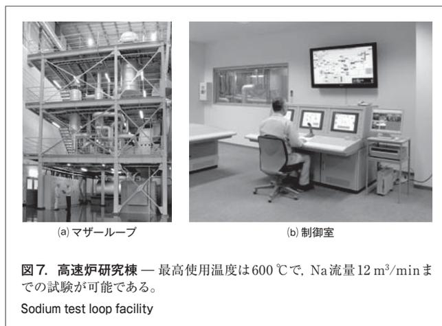
Na流量は12 m<sup>3</sup>/minまでの試験がこの設備で可能である。
