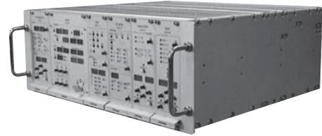
図2. FPGAを使用したSRNMユニット — 高信頼性と長期安定供給に応えるために開発したFPGA型TOSDIA<sub>TM</sub>の代表例である。
