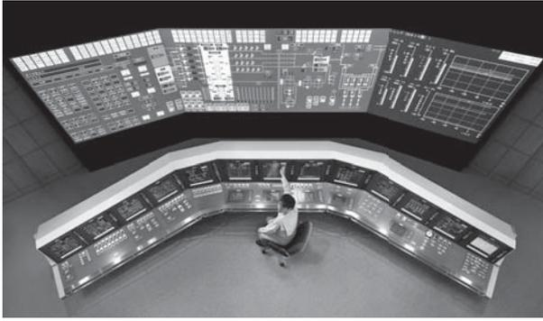
図1. HFE評価設備(日本設置) — 実際の中央制御盤と同等な環境で画面表示色やシンボルなどを変更し、ヒューマンファクターを評価できる。
