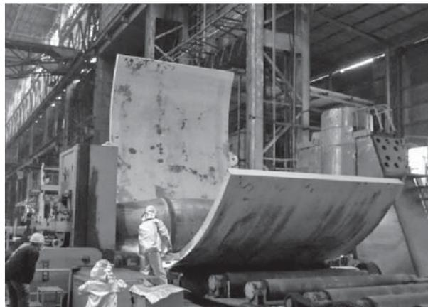
図6. STP3号機 原子炉圧力容器製造状況 — (株)IHI横浜第一工場
